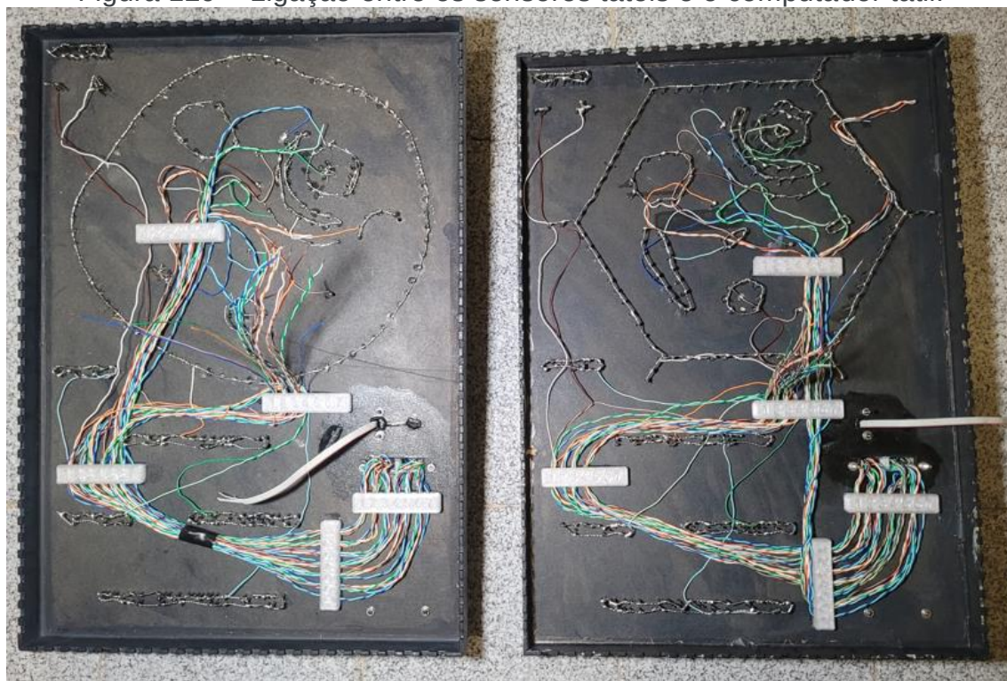
Figura 129 – Ligação entre os sensores táteis e o computador tátil.
