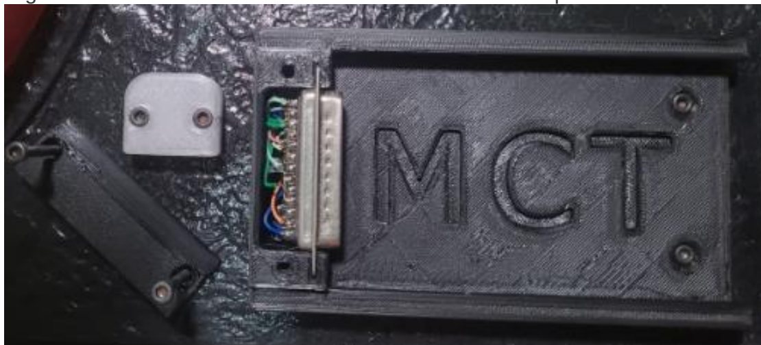
Figura 83 – A visão interna da caixa deslizante do computador tátil do MCT.
