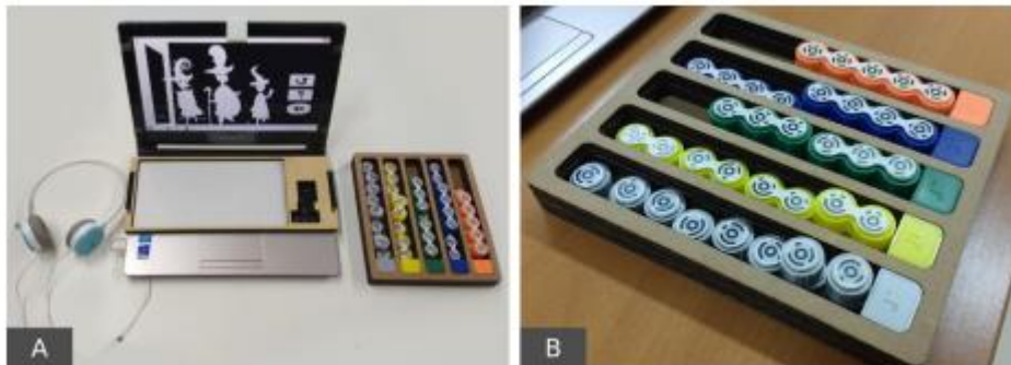
Figura 6: (A) Representação do iCETA com fone, computador, espelho, área de trabalho e blocos. (B) Caixa com blocos representando os números de 1 a 5.
